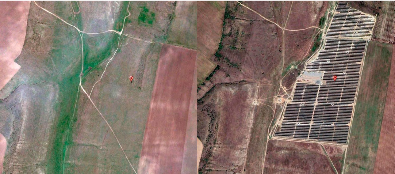
Фіг. 2. Приклад будівництва СЕС на схилах степового яру в Миколаївській області за супутниковими знімками 2018 та 2020 рр. Джерело: Google Maps
