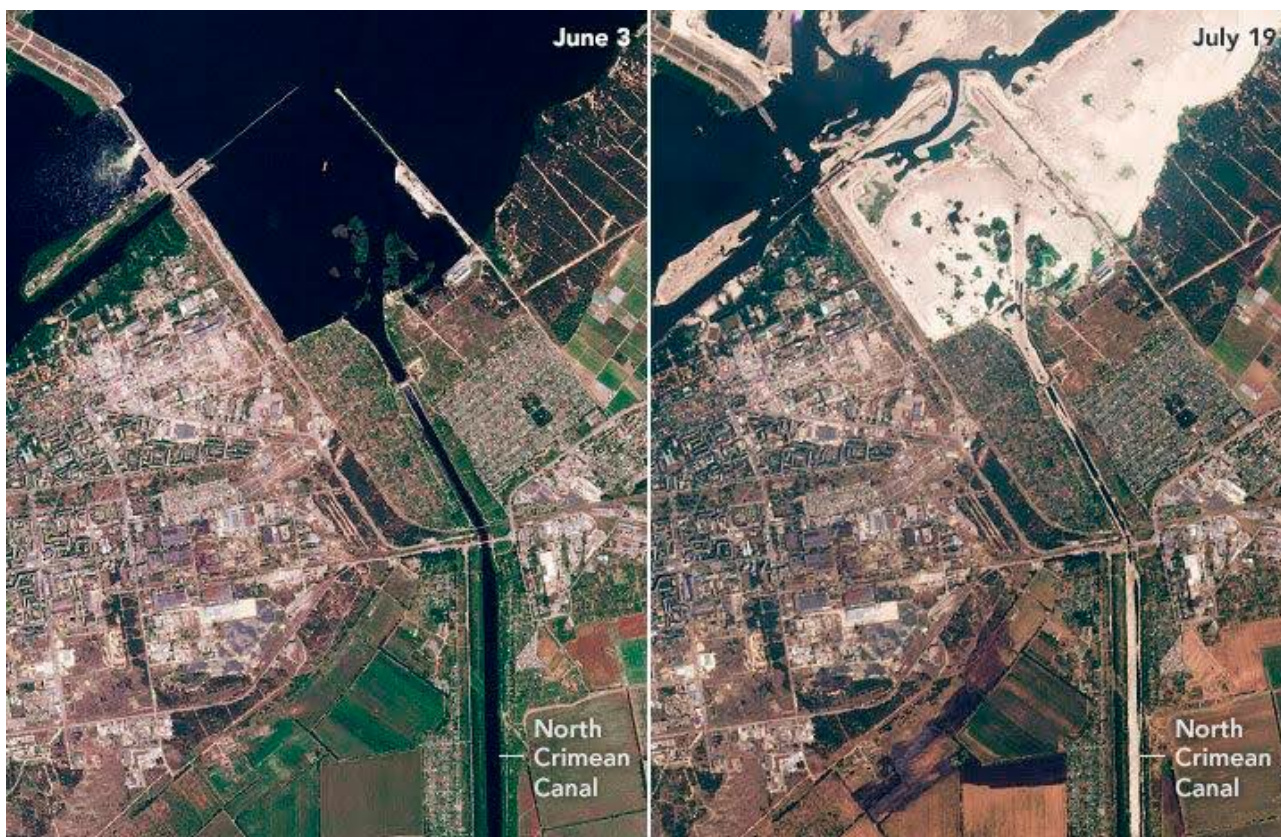
Оголовок СКК с водой и без воды до и после подрыва Каховской ГЭС. Источник: earthobservatory.nasa.gov
