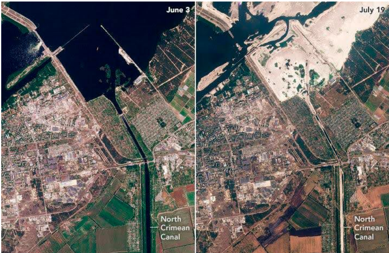
Оголовок ПКК з водою та без води – до та після підриву Каховської ГЕС. Джерело: earthobservatory.nasa.gov
